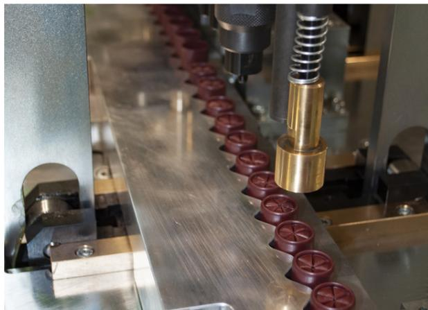
*Helios è la macchina caricatrice compatta per cartucce da caccia e tiro sportivo di LM elettrotecnica. Helios nasce come macchina multicalibro, ideale per tutti i caricamenti speciali e piccoli lotti di produzione, raggiungendo una produzione oraria di 4500 pz/h. I movimenti di traslazione e dosatura sono azionati da assi elettrici che garantiscono risparmio energetico durante le fasi di lavorazione e di produrre cartucce di alta qualità.*
